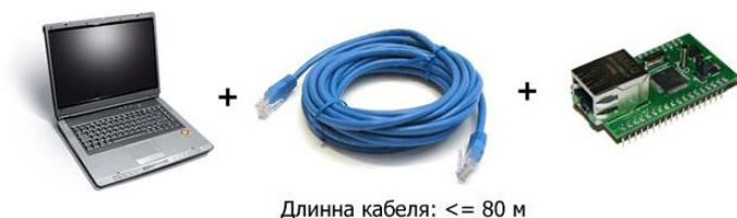
Рис. Схема прямого сетевого подключения компьютер - модуль
