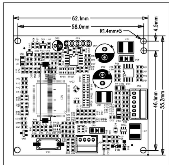
Рис.3 Установочные размеры
