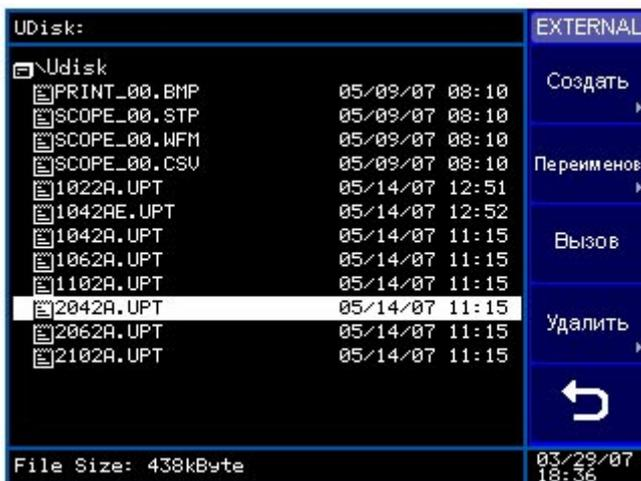
Кроме возможности сохранения через файловую систему, имеется возможность быстрого сохранения экрана посредством специальной кнопки расположенной на передней панели осциллографа . Вместо подключения USB-накопителя также предусмотрена возможность подключения к данному интерфейсу и USB-принтера с возможностью выбора параметров печати: монохромный или цветной режим.
