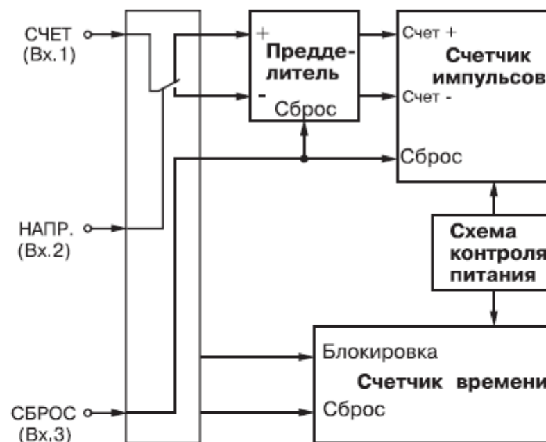
Рис. 13. Реверсивный счет с общим счетным входом, с заданием направления счета внешним сигналом и внешним сбросом
