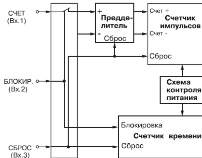
Рис.15 Прямой счет с блокировкой и сбросом счетчиков импульсов и времени
