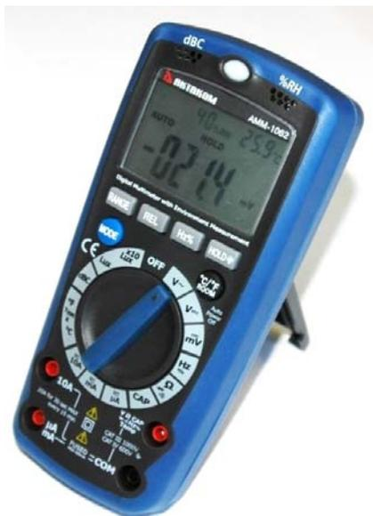
Комбинированный мультиметр "6 в 1" АММ-1062 сочетает в себе функции измерения как электрических так и физических величин: температуры, влажности, уровня шума и освещённости.
