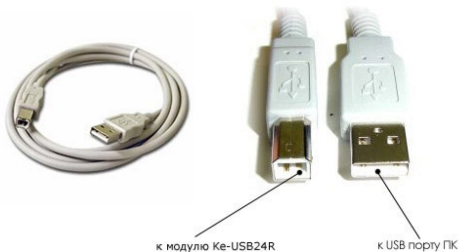
Рис. Кабель USB-AB для подключения модуля к компьютеру.
