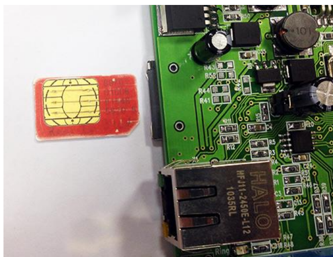
Рис. Установка SIM карты в модуль Laurent-2G
