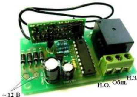
Рис.1 Общий вид изделия и подключение
