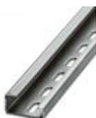
G-образная монтажная рейка, материал: сталь, с отверстиями, высота 15 мм, ширина 32 мм, длина 2 м
