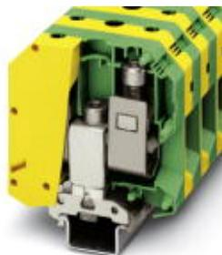
Клемма защитного провода, Тип подключения: Винтовые зажимы, Сечение: 25 мм<sup>2</sup> - 95 мм<sup>2</sup>, AWG: 4 - 3/0, Ширина: 25 мм, Цвет: желто-зел., Тип монтажа: NS 35/15, NS 32
