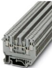
1-ярусный клеммный блок, с двухсторонним расположением сдвоенных контактов, сечение: 0,2 - 2,5 мм<sup>2</sup>, AWG: 30 - 12, ширина: 5,2 мм, цвет: серый
