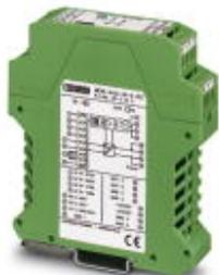
Измерительный преобразователь сигнала напряжения MCR, для переменного напряжения от 0...20 В до 0...440 В, выходной сигнал 0...10 В / 0(4)...20 мА
