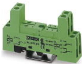
Установочный блок (основание) PR1... для мощных миниатюрных реле или мини-реле с 1 или 2 переключающими контактами или для имеющих сходную конструкцию полупроводниковых реле, 2/2-ярусное исполнение, винтовые зажимы, возможность установки вводных модулей и модулей подавления помех
