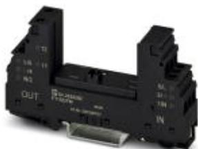
Базовый элемент для защитного штекера PT, устанавливается на рейку NS 35/7,5 и NS35/15, ширина прибора: 17,5 мм
