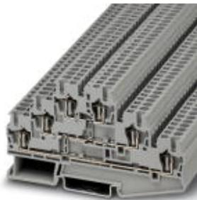
Многоярусный клеммный модуль, Тип подключения: Пружинный зажим, Сечение: 0,08 мм<sup>2</sup> - 4 мм<sup>2</sup>, AWG: 28 - 12, Ширина: 5,2 мм, Цвет: серый, Тип монтажа: NS 35/7,5, NS 35/15
