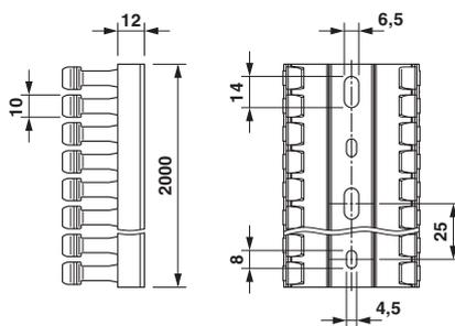
Расположение отверстий в днище соответствует требованиям DIN EN 50085
