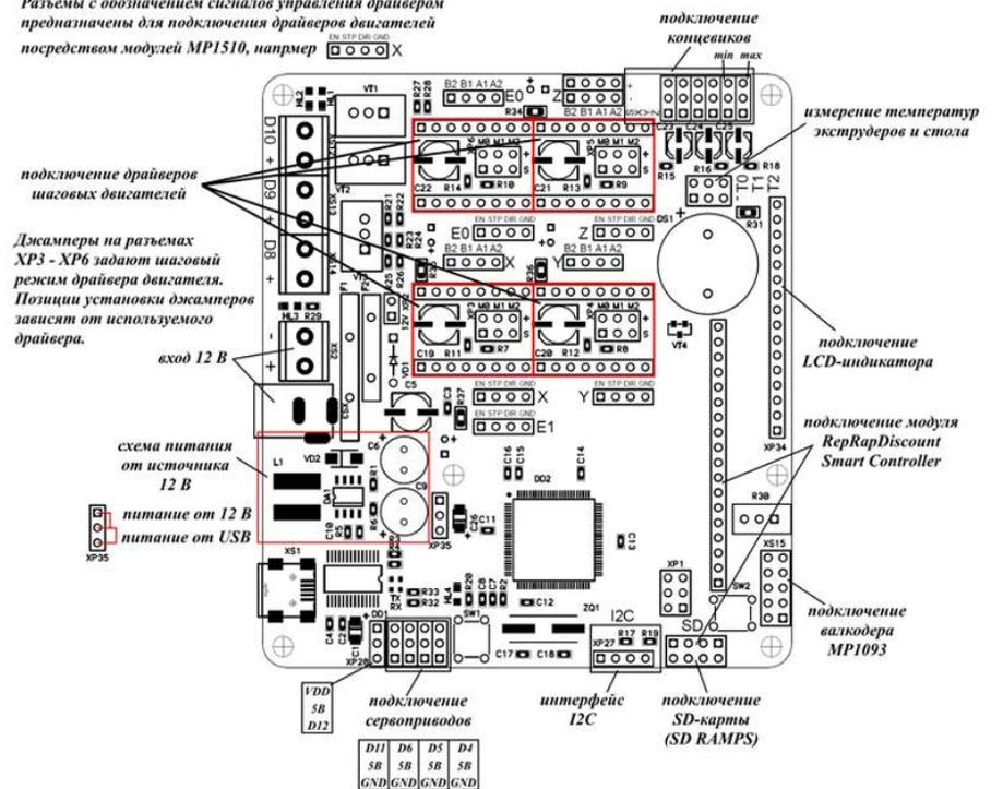
Рис. 2 Плата Mastertronics. Назначение разъемов.
