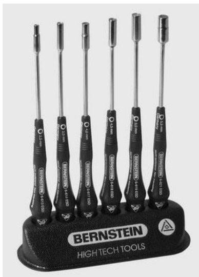
**Набор из 6 хромованадиевых радиомонтажных торцевых ключей** длиной 160мм (в т.ч. антистатическая рукоятка длиной 90мм) общим весом 156г, на антистатической подставке. Рабочая часть - накладная для шестигранников размером 2,0мм; 3,0мм; 4,0мм; 4,5мм; 5,0мм; 5,5мм
