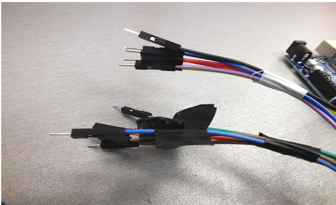
Заведем провода GND на общую шину. В качестве шины можно использовать: монтажную колодку, планку от металлического конструктора, скрутку, пайку. Шину подсоединим проводом к разъему GND на электронной плате. Аналогично поступаем с проводами +. Подсоединяем провод + к разъему 5V на электронной плате.
