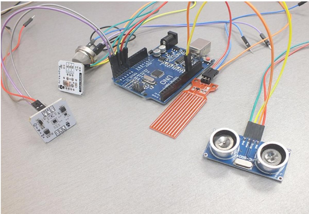
8. Подсоедините датчик Огня к Электронной плате воткнув сигнальный провод в разъем 10D
