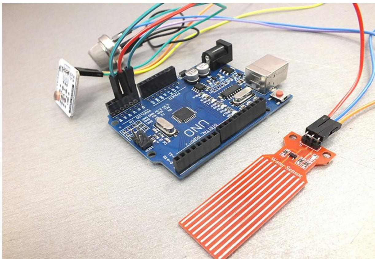
6. Подсоедините Барометр к Электронной плате воткнув провод D в разъем A4, а С в разъем A5
