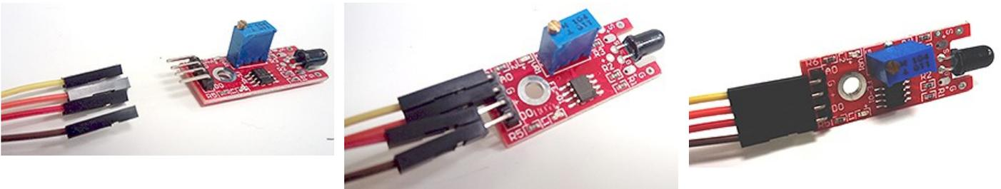
3. Подсоедините датчик воды к Электронной плате воткнув сигнальный провод в разъем А1
