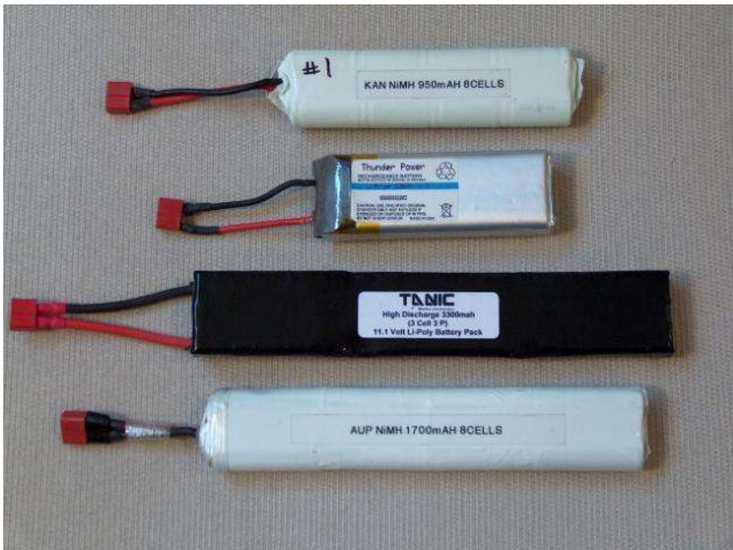
Очень хорошо зарекомендовали себя литий-полимерные аккумуляторы на небольших вертолётах, таких, как Piccolo или Hummingbird – например, даже при использовании стандартного коллекторного мотора время полёта на двух банках ёмкостью 1 А\*ч составляет более 25 минут! А при замене мотора на бесколлекторный – более 45 минут!
