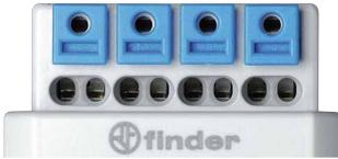
Двойные клеммы обеспечивают удобный монтаж перемечек между несколькими приборами. Макс.сечение провода для каждой клеммы составляет 2.5 мм<sup>2</sup>.
