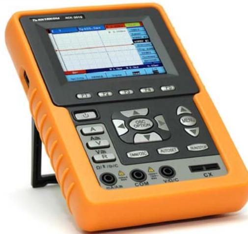
Осциллограф цифровой АСК-2018 предназначен для визуального наблюдения сигнала и сохранения его для дальнейшей обработки
