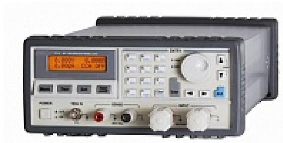
Электронная программируемая нагрузка с возможностью дистанционного управления, предназначена для работы в качестве нагрузки при испытании, настройке и регулировке блоков питания, усилителей, звуковоспроизводящей аппаратуры и других радиотехнических устройств с напряжением питания до 80 В, током нагрузки до 40 А, потребляемой мощностью до 400 Вт.
