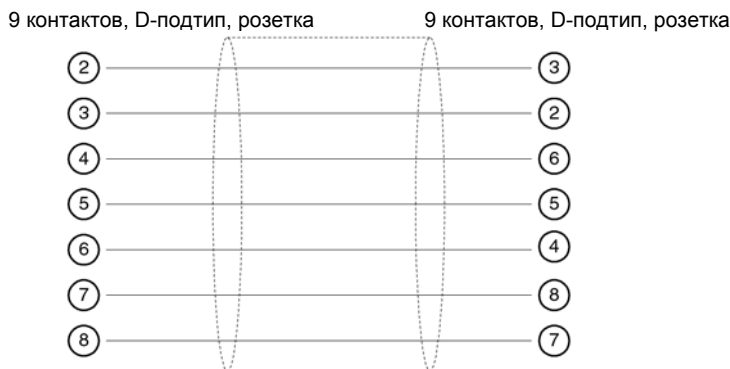
Рисунок 8.3. Схема перекрестного кабеля RS-232C, для справки
