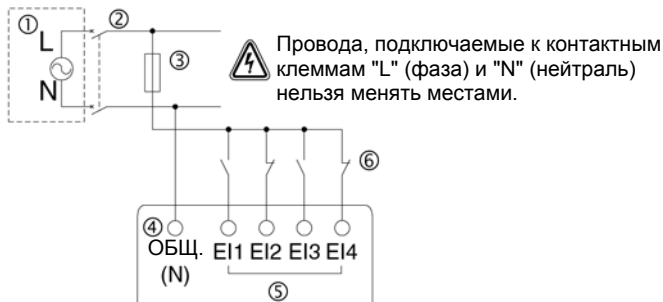
Рисунок 4.4: Схема электрических соединений с входными цепями, для AL2-4EX-A2
