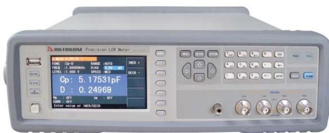
Прецизионный LCR-метр АММ-3048, обладающий высокой точностью измерения (0,05%) и функциональностью, позволяет проводить измерения на высокой тестовой частоте. Имеет небольшие габаритные размеры и вес. Два измеренных параметра и служебная информация отображается на цветном 4,3" ЖК дисплее. Приборы имеют встроенную функцию проверки трансформаторов, встроенный компаратор, возможность работы по списку и широкие возможности по подключению к ПК.
