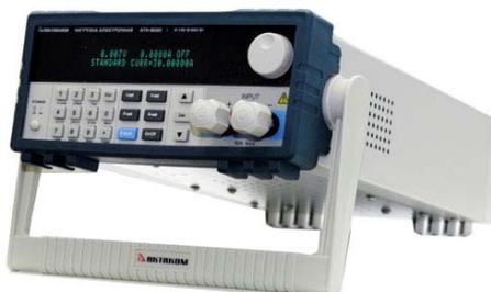
Программируемая электронная нагрузка предназначена для работы в качестве нагрузки при испытании, настройке и регулировке блоков питания, усилителей, звуковоспроизводящей аппаратуры и других радиотехнических устройств с напряжением питания до 150 В, током нагрузки до 20 А, мощность поглощения до 300 Вт.
