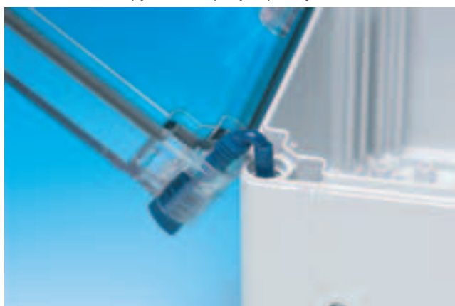
Шарнирные винты крышки синего цвета. Головка под отвертку крестообразную/шлицевую (Артикул OLCH1) , либо барашек (Артикул OLWH1). Материал полиамид.
