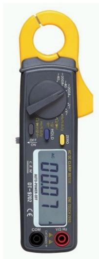
Токовые клещи DT-9702 позволяют производить бесконтактное измерение постоянного и переменного тока в диапазонах 40 А и 200 А. Обладают высоким разрешением при измерении постоянного и переменного тока (10 мА при диапазоне 40 А). Наличие функции установки нуля при измерении постоянного тока, нажатием кнопки "ZERO". Внутренний диаметр клещей 23 мм.
