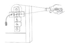
Попробуйте использовать зеркала для преломления светового луча по углам. Убедитесь, что свет все еще попадает на фотоэлементе.
