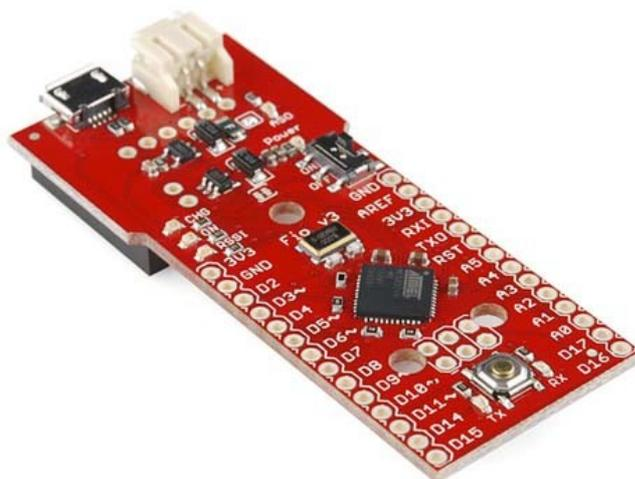
**Описание:** Новый ARDUINO совместимый контроллер от SPARKFUN Fio v3 - реализован на микроконтроллере ATmega32U4. Разъем JST и напряжение питания 3,3В, делают этот миниатюрный модуль великолепным решением для портативных устройств. Для начала работы с ним, просто подключите Li-Poly аккумулятор. Беспроводные сенсорные и коммуникационные сети легки в реализации, благодаря разъему XBee на плате.
