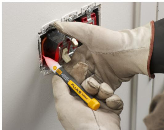
Работать с бесконтактным тестером переменного напряжения нового поколения VoltAlert™ от компании Fluke очень легко. Просто дотроньтесь наконечником до клеммной коробки, вывода или кабеля. При наличии напряжения наконечник становится красным. Электрики, ремонтники, персонал по обслуживанию и безопасности, а также домовладельцы могут быстро и безопасно проверить наличие напряжения в сети как в производственных, так и в домашних условиях.
