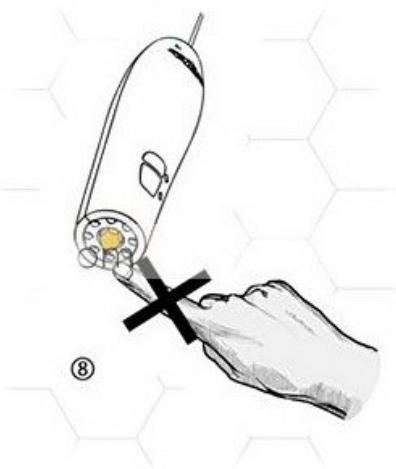
Когда нить почти закончилась, и её на поверхности осталось 3-5 сантиметров, просьба остатки вынуть из ручки и заменить на новый отрезок. В противном случае, остатки могут засорить протяжный канал, что может вывести ручку из строя. См. рисунок 9-10.
