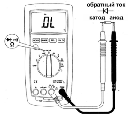
Рисунок 5. Проверка диодов
