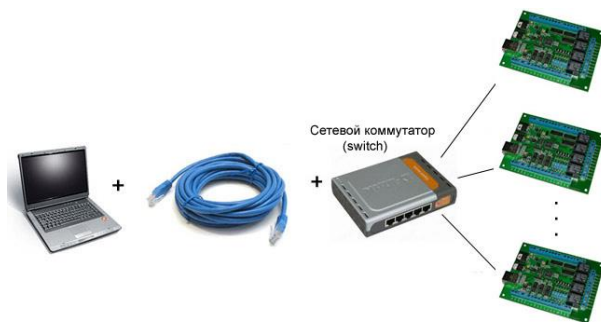
Рис. Схема подключения нескольких модулей к одной сети с использованием роутера
