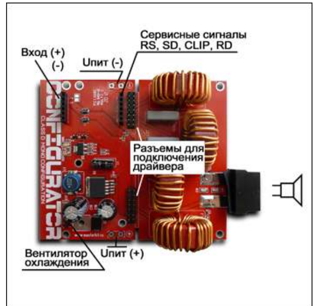
Рис.3 Назначение разъемов
