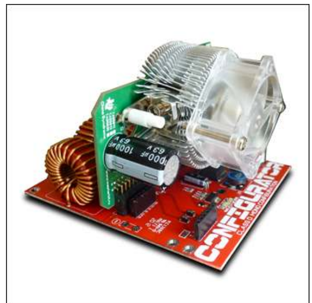
Рис.4 Конфигуратор MP5630C1 с драйвером MP5630D и радиатором SL-01H
