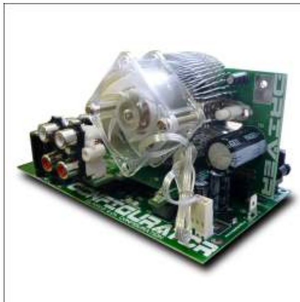
Рис.4 Конфигуратор MP5630C4 с драйвером MP5630D, индикатором MP5630I4 и радиатором SL-01H
