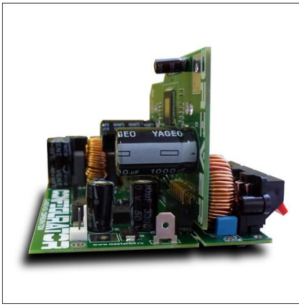
рис.3 Конфигуратор MP5630C4 с драйвером MP5630D
