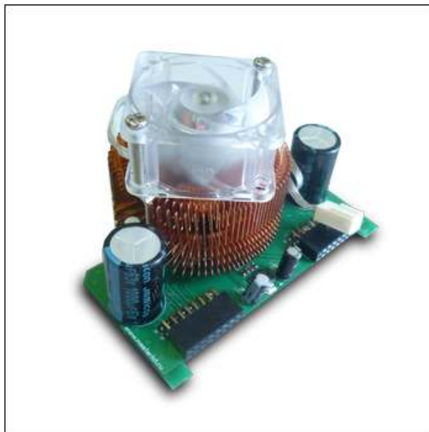
Рис.1 Внешний вид драйвера MP5630DKD с теплоотводом.
