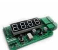
MP8037ADC – Одноканальный АЦП с тремя режимами работы.
