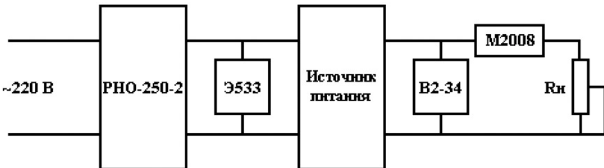
Рисунок 1. Структурная схема измерения нестабильности выходного напряжения при измерении напряжения питающей сети в режиме стабилизации напряжения.
