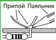
Распределение расплавленного припоя равномерно вокруг вывода компонента.
