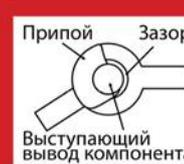
Неполное покрытие припоем контактной площадки и вывода элемента - контакт ненадежный.
