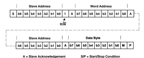
Figure 3–13. Serial Bus Protocol – Byte Read
