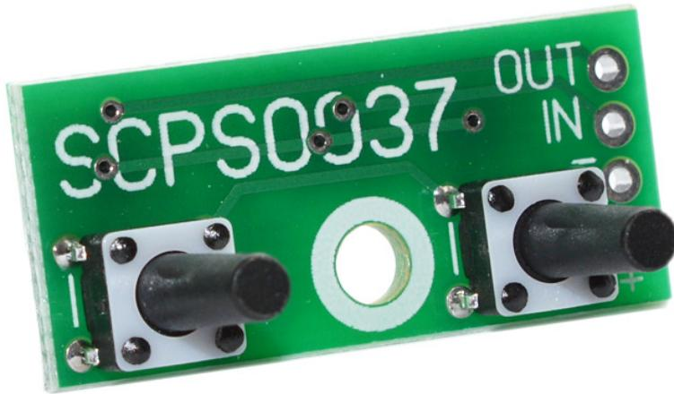
Контроллер импульсного стабилизатора предназначен для кнопочной регулировки выходного напряжения в импульсных стабилизаторах напряжения, таких как **SCV0023**, **SCV0026**, **SCV0033** и аналогичных. Модуль позволяет регулировать выходное напряжение стабилизатора в указанном диапазоне с шагом регулирования при помощи кнопок.
