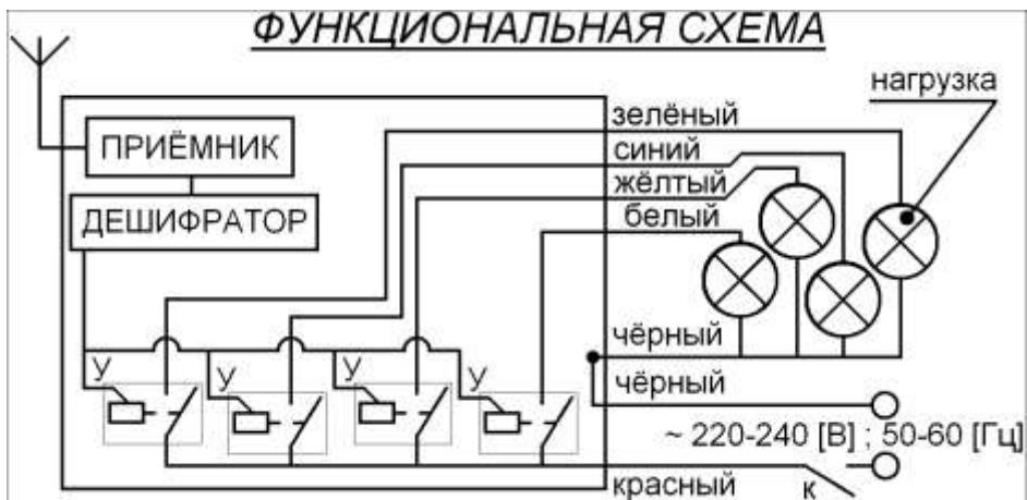
Семейство дистанционных выключателей BEAMISH предназначено для коммутации тока переменного напряжения до 240 В с силой тока до 10 А.
