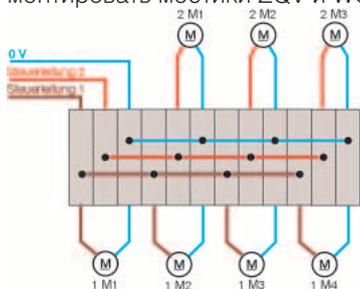
**Внимание!** Для укороченных мостиков ZQV, расположенных рядом (с неизолированными краями), следует ставить концевые пластины или разделители для сохранения рабочего напряжения 250 V
