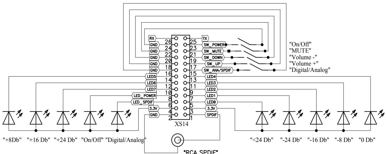
Рис. 5 Схема подключения внешних светодиодов, кнопок и разъема SPDIF
