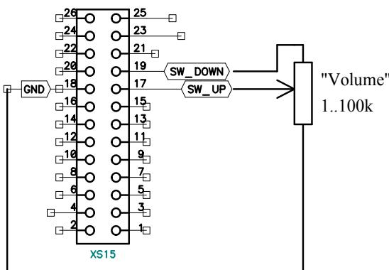
Рис. 6 Схема подключения резистора регулировки громкости
