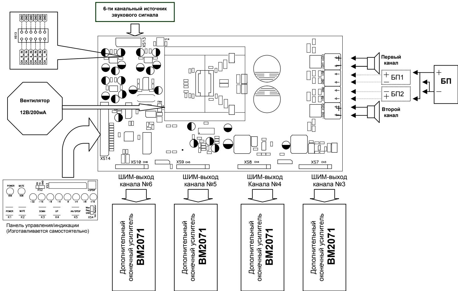
Рис. 7 Схема подключения усилителя
