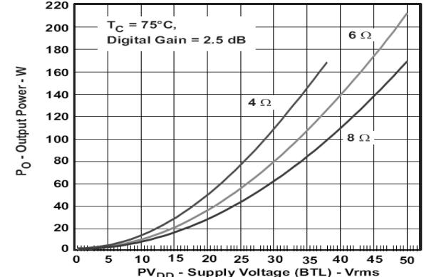
Рис. 3 Зависимость выходной мощности P<sub>O</sub> от напряжения питания PV<sub>DD</sub>
