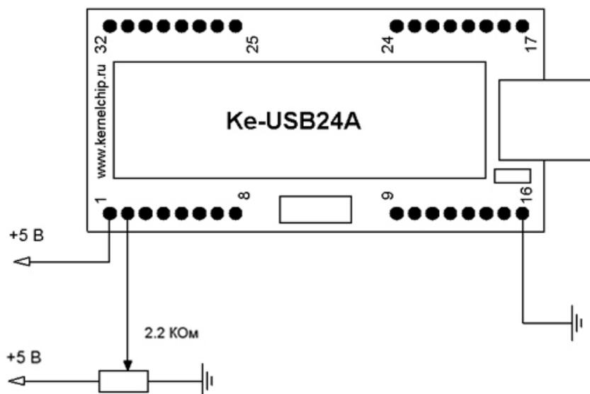
Для единичного получения цифрового кода, соответствующего напряжению на входе АЦП необходимо подать команду \$KE,ADC. Мы получим, например, вот такой ответ:
