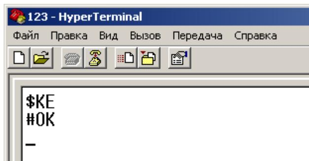
Давайте используем еще одну простую команду – команду получения серийного номера модуля. Каждый модуль имеет свой собственный уникальный серийный номер, хранящийся в энергонезависимой памяти. Набираем **\$KE,SER** и, например, получаем вот такой ответ:
