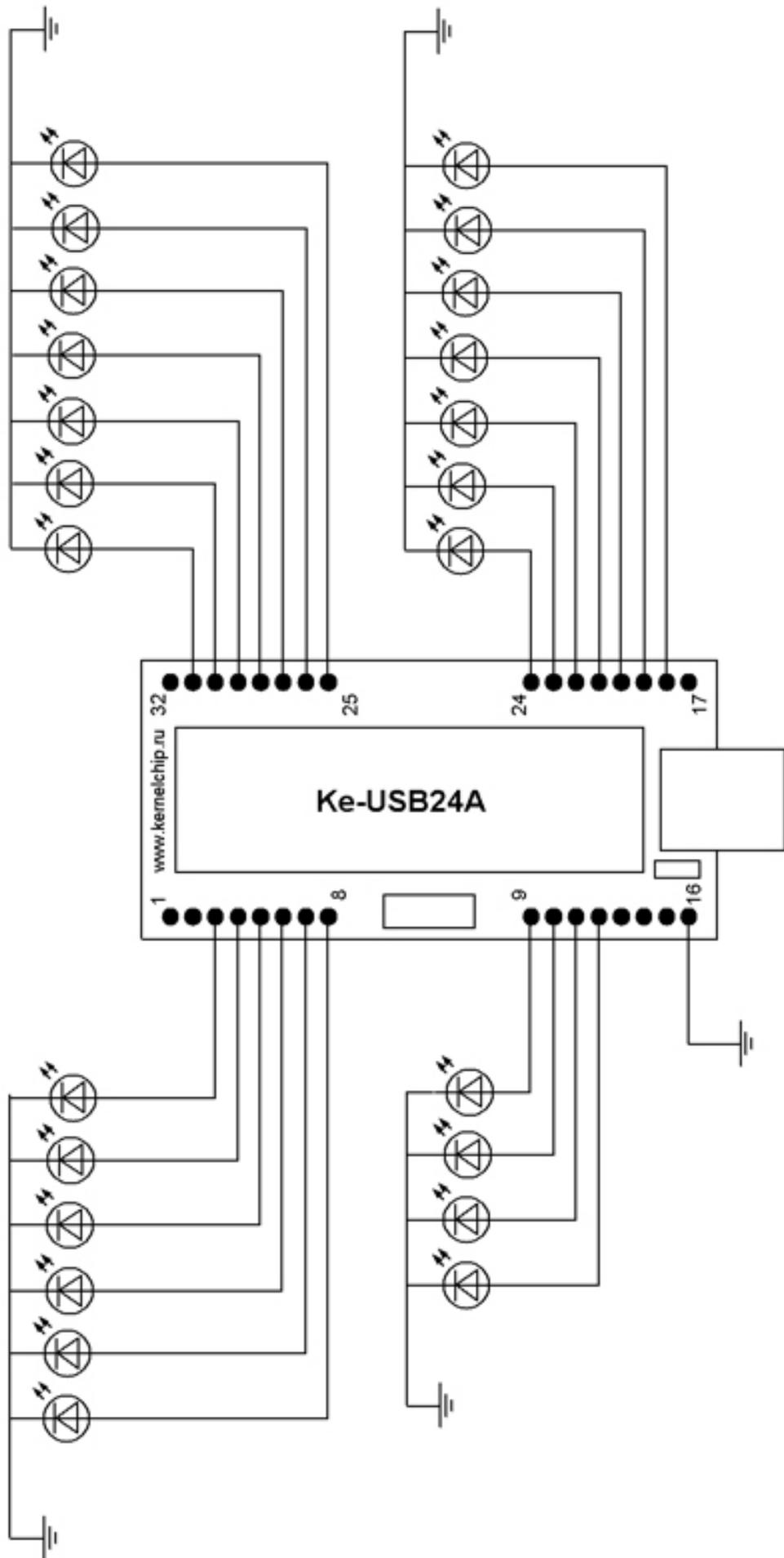
Чтобы потушить тот или иной светодиод, необходимо установить на соответствующей линии низкий уровень напряжения, путем отправки команды записи с последним параметром равным нулю. Например, потушим светодиод, подключенный к линии ввода/вывода под номером 1 (вывод модуля 3):
