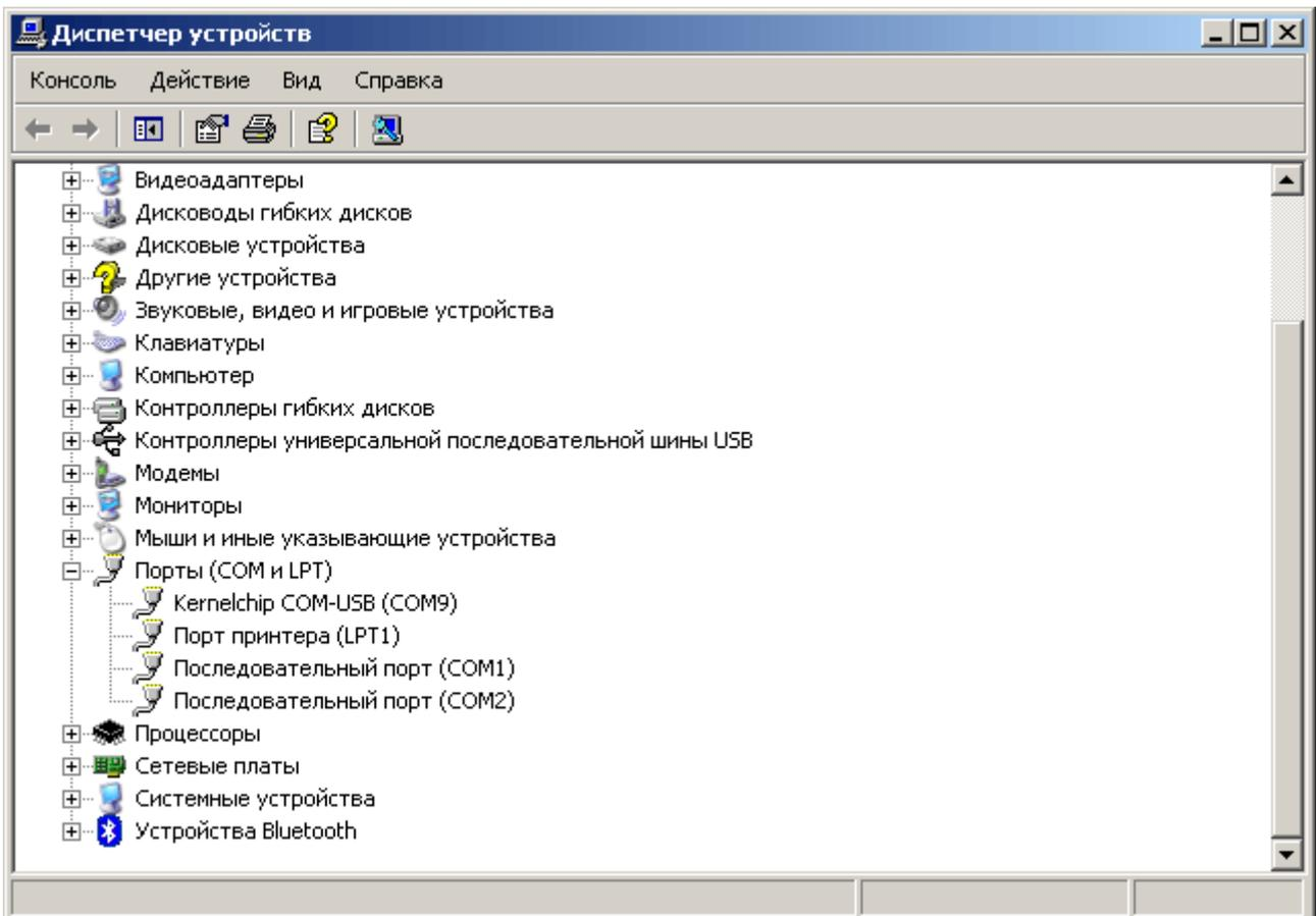
Для управления модулем в общем случае можно использовать любую терминальную программу, имеющую возможность работы с COM портами. Здесь мы рассмотрим использование программы *HyperTerminal*, входящей в состав ОС Windows XP и программу *KeTerm* специально предназначенную для работы с Ke-USB24A.
