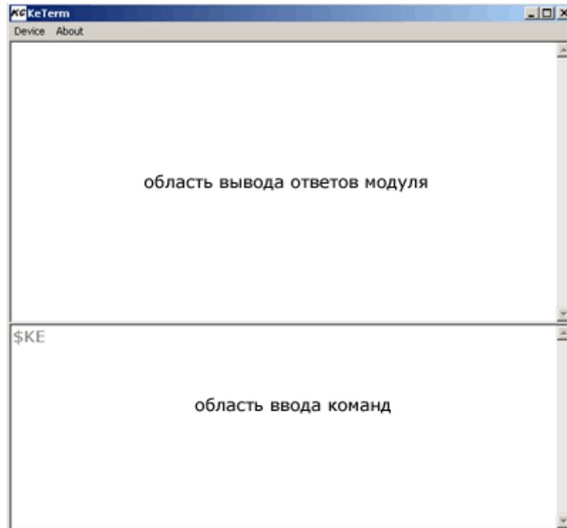
После запуска программы область ввода команд неактивна. Для начала работы необходимо подключиться к модулю, указав номер COM порта к которому он подключен. Для этого выбираем в меню *Device* -> *Connect*. В появившемся окне указываем номер порта 9 (у Вас он может быть другим; определить можно в диспетчере устройств, см. выше) и нажимаем кнопку "ОК". Если порт свободен и модуль подключен, область ввода команд будет активирована. В противном случае получим сообщение об ошибке открытия порта.
