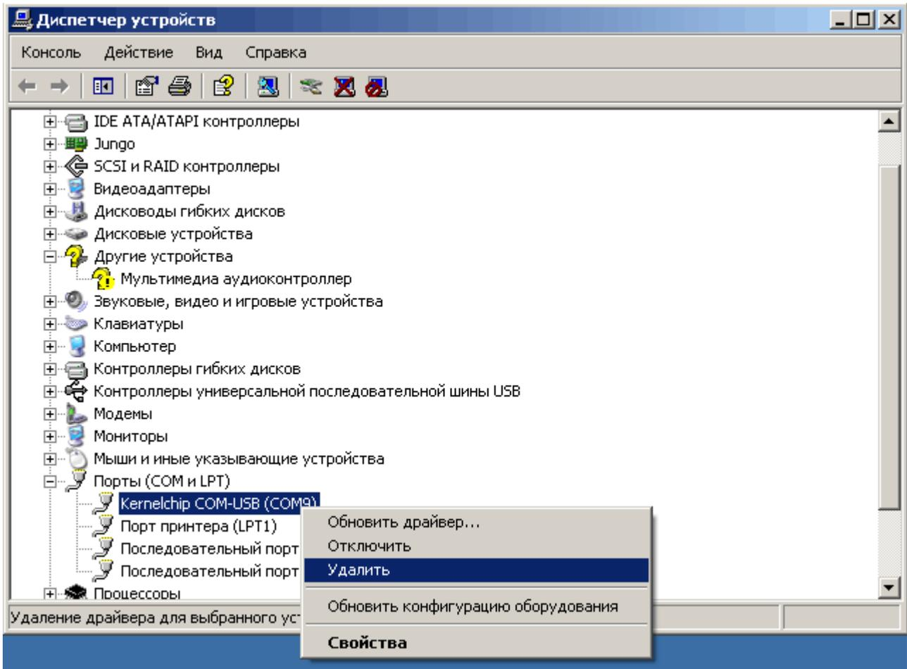
Появится сообщение с предупреждением. Нажимаем "ОК". При этом устройство исчезнет из диспетчера устройств и мы услышим характерный звуковой сигнал отключающегося USB устройства.
