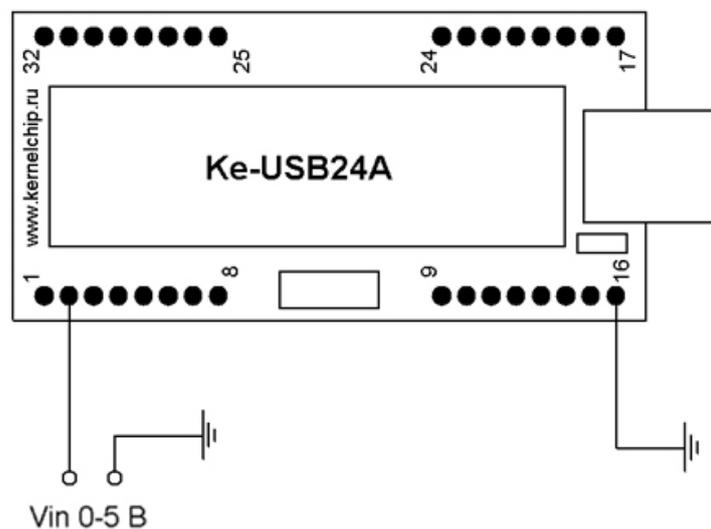
Для стартового ознакомления с возможностями АЦП модуля Ke-USB24A предлагается следующая схема, показанная на рисунке ниже. На вход АЦП будет подаваться напряжение, снимаемое с движка переменного резистора. Изменяя положение движка можем получать любое напряжение в диапазоне от 0 до 5 В.
