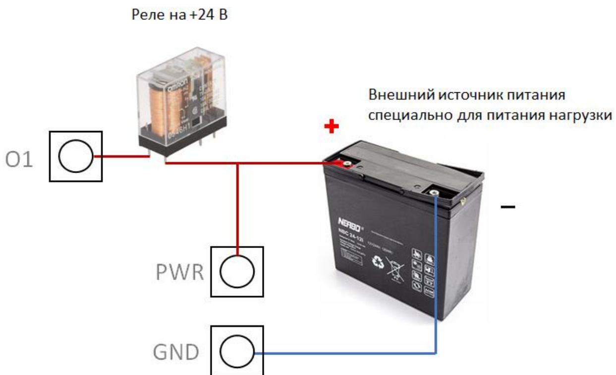
Рис. Подключение внешнего реле на +24 В. В данном случае рассмотрим ситуацию, когда питание нагрузки осуществляется независимым источником питания.
