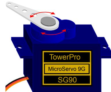
Рис. 12.1. Внешний вид сервопривода
