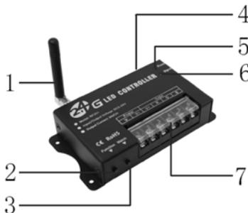
6. Индикатор приема сигнала (Signal). Индикатор моргает при получении радиосигнала от пульта ДУ
